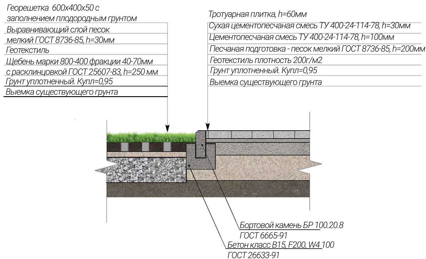
КОНСТРУКЦИЯ СТЫКА ТРОТУАРНОГО ПОКРЫТИЯ ПЕШЕХОДНЫХ ЗОН И ПОКРЫТИЯ ИЗ ГЕОРЕШЕТКИ ПАРКОВОЧНОЙ ЗОНЫ
