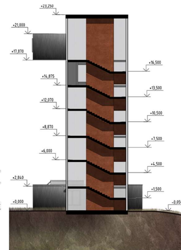
Смотровая башня. Разрез
