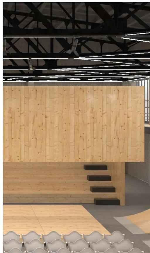
Концепция освещения для сценариев «Лекция» и «Ярмарка». Яркое освещение достигается включением фонового освещения и локальных светильников над рабочими зонами.
